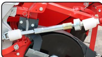
Transmisión individual en cada unidad con tornillo fusible y alarma sonora. Además engranes de acero.
