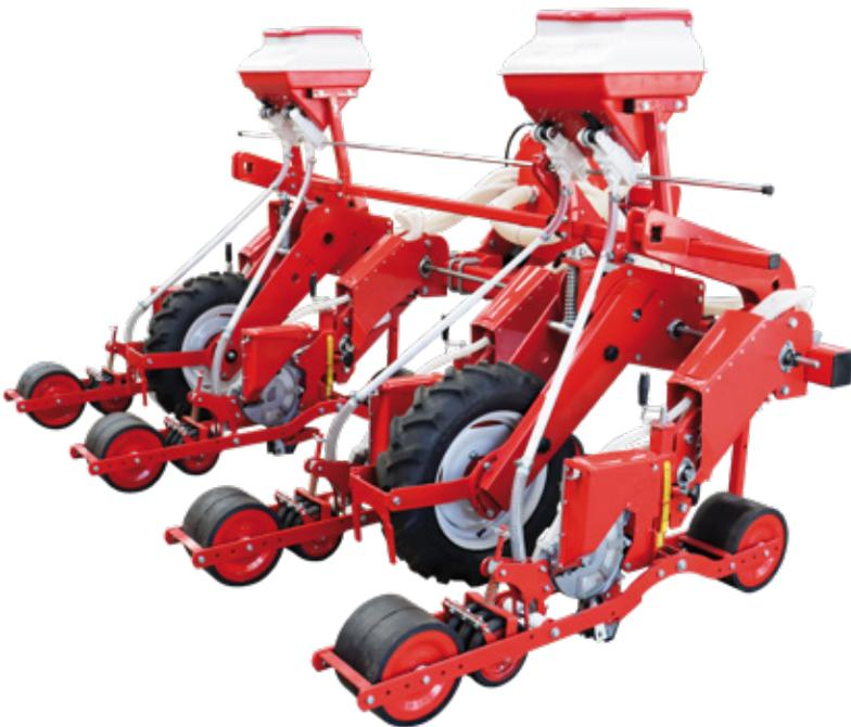
Sembradora neumática, ideal para semillas peletizadas. Si desea sembrar sin claros ni dobles y busca productividad, este es el equipo ideal, ya que gracias a su sistema, la semilla es adherida a un disco por medio de succión de aire y depositada o sembrada una por una con una precisión insuperable garantizando su germinación uniforme.
