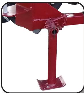
Patatas soporte delantera y trasera para posición de trabajo.
