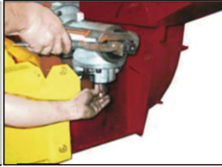
Imagen 14. Cambio del perno fusible
