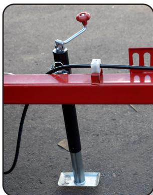
Pata para soporte, de activación mecánica
