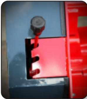
Palanca de ajuste de tensión de bandas en 3 posiciones.
