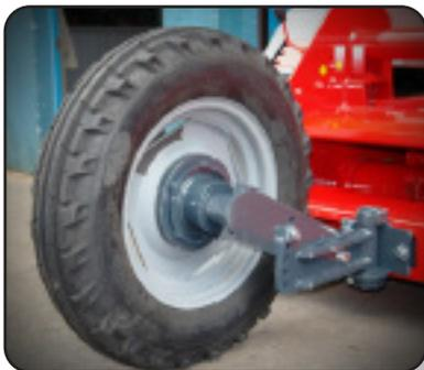
2 llantas (6.00-16) de uso agrícola abatibles, con posición fija para transporte (plegadas) y posición de movimiento libre para trabajo. Y 15 posiciones para control de altura.
