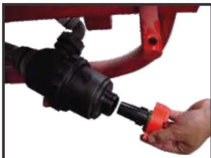
**A)** Retire el tapón del filtro de succión presionando hacia el filtro y dando 1/3 de giro hacia la izquierda.
