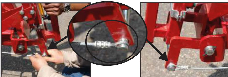
Una vez colocados los dos aguilones inserte el cable equilibrador localizado en la parte posterior de los aguilones en ambos lados.
