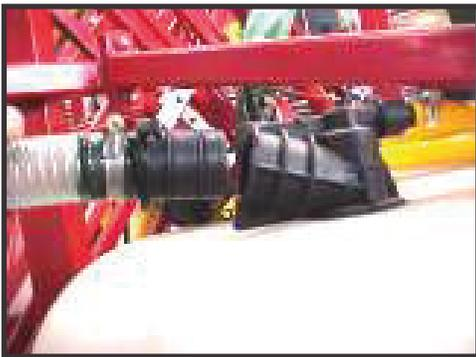
A) Retire la tapa del hidrollenador e inserte la manguera de succión con los arosellos del niple previamente engrasados y girelo para sujetarlo.
