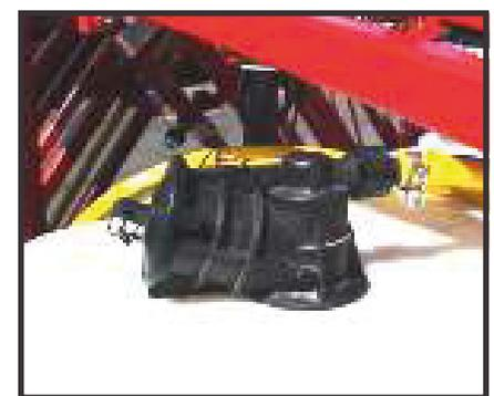
E) Al término de llenado, cierre la llave del hidrollenador y retire la manguera colocando a tapa del hidrollenador.
