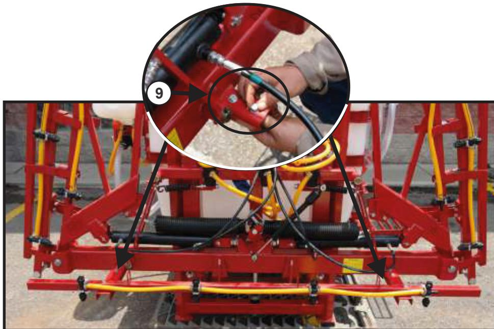
Para conectar las mangueras de los aguilones a los filtros proceda de la siguiente manera: conecte la manguera del aguilón izquierdo y abrazaderas, como se aprecia en la imagen de la izquierda y conecte la manguera al filtro izquierdo. Repita lo mismo del lado derecho. Por último conecte la manguera del aguilón central y fíjela con las abrazaderas como se muestra en la imagen.
