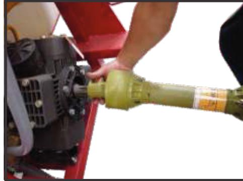
**NOTA:** Identifique que tractor va a utilizar con la aspersora GAVIOTA y proceda a cortar el eje cardán de acuerdo al requerimiento de ese tractor.
