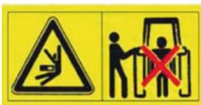
2. Asegúrese de que no haya nadie entre la máquina y el tractor cuando la máquina esté conectada a este. Utilice un sistema de frenado o cuñas para eliminar el riesgo de deslizamiento.
