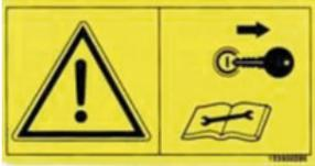
5. Antes de empezar un procedimiento de reparación, mantenimiento o limpieza de la maquinaria, colóquela en el suelo, pare el motor, saque la llave de encendido y desconecte la TDF.
