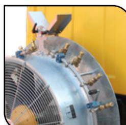
Boquillas dobles de 1.5 y con antigoteo ajustable 1.8 mm.
