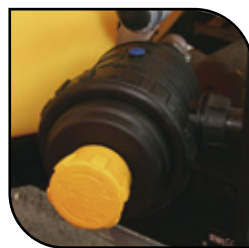
Filtro con check integrado.
