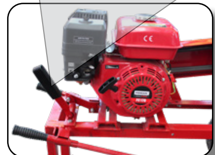
Palanca para aflojar las bandas que facilita el arranque del motor y tensarlas para su funcionamiento.
