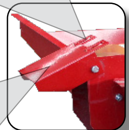
Ganchos para sostener un costal
