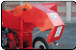
Boca de salida con contrapeso
