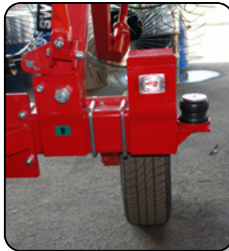
Amortiguadores bumper compactos y resistentes que absorben los golpes y movimientos bruscos de los brazos
