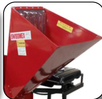
2 bocas de alimentación con cortinas de seguridad que evitan la salida de material.
