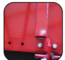
Huecos para descentrar el equipo y hacer cortes laterales.
