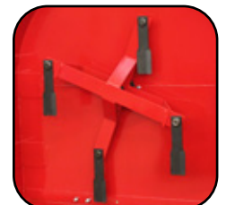
4 navajas de acero templado especial de doble filo con ángulo apropiado de corte.
