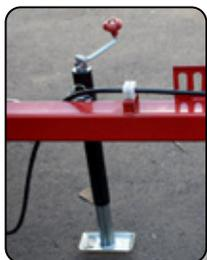
Pata para soporte, de activación mecánica
