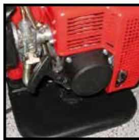
Cordón retráctil para el encendido del motor.
