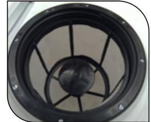
Mezclador Hidráulico para polvos humectables directamente en el tanque, ahorre tiempo, ya que no necesitará realizar su mezcla en un contenedor a parte
