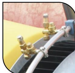
Boquillas dobles de 1.5 mm fija y 1.8 mm ajustables.
