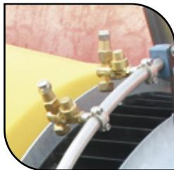
Boquillas dobles de 1.5 mm fija y 1.8 mm ajustables.
