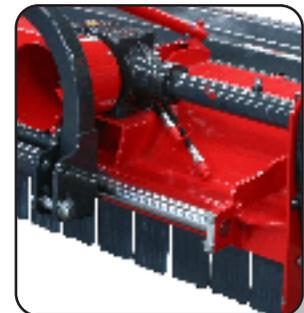
Entrada de alimentación con cortinas metálicas abatibles que permiten la entrada del material a la carcaza de molienda, y evita su salida, brindando así protección y seguridad al operador.
