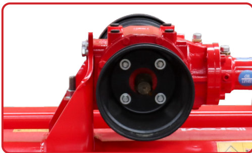
Robusta transmisión con engranes en baño de aceite
