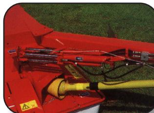
Su mando hidráulico le permite hacer el giro de la lanza por medio de un cilindro de doble efecto.
