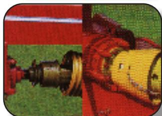
Equipada con 2 ejes de transmisión; uno de rueda libre y uno con clutch, aseguran un funcionamiento sin problemas, además de tener una alta protección para las piezas vitales.
