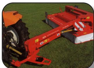
El cabezal Girodyne le ofrece la seguridad de que la transmisión siempre permanecerá en una perfecta alineación con el tractor, incluso en las curvas mas cerradas. Reduce el tiempo en maniobras, principalmente en parcelas pequeñas.
