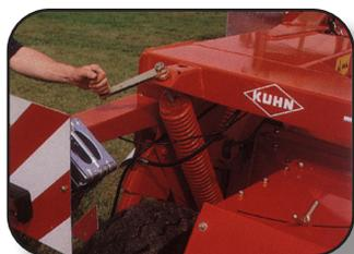
Equipada con resortes de aligeramiento de tensión regulable, le permiten modular la presión al suelo en función de la capacidad del terreno y de la velocidad de trabajo. El ajuste es muy simple, sin necesidad de herramientas, en tan solo unos instantes mediante manivelas.
