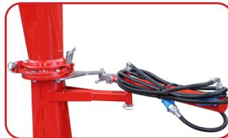
Tubo de descarga con movimiento hidráulico
