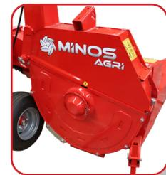
Volante de picado con 12 navajas y 6 palas lanzadoras
