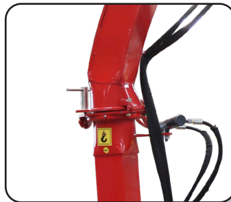
Tubo de descarga con movimiento hidráulico
