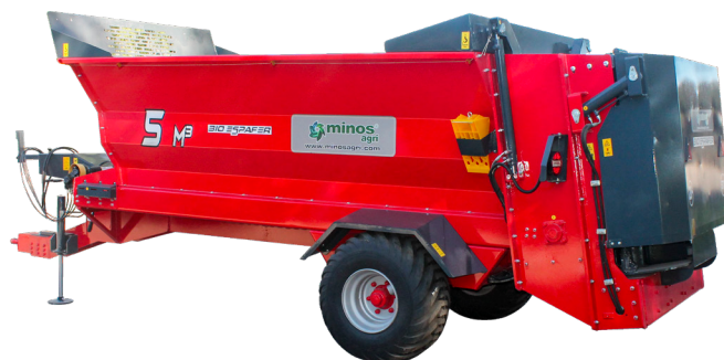
Aplicación trasera esparcida para fertilizantes húmedos
