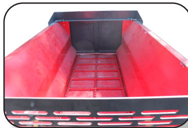
BANDA TRANSPORTADORA POR CADENA Y SISTEMA HIDRÁULICO
