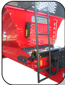
ESCALERA Y BALCÓN PARA INSPECCIÓN
