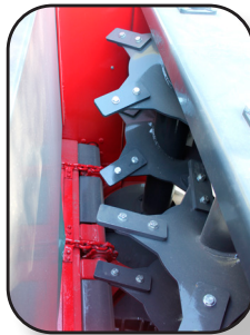
2 ROTORES VERTICALES CON 10 CUCHILLAS REMPLAZABLES
