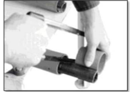
Figura 14.c Acortamiento del eje de la toma de fuerza.
