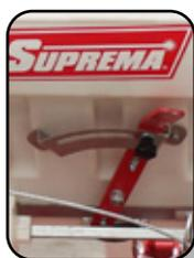
Con un solo mando por depósito usted puede controlar las salidas del fertilizante y puede seleccionar de 22 a 630 Kg / hectárea (rápido, eficiente y seguro).
