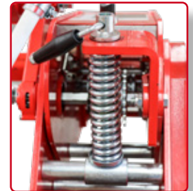
Resorte para darle presión a la llanta de tracción
