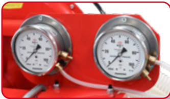
Vacuómetros para indicar la presión de succión
