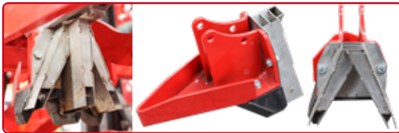
Chuzos intercambiables dobles o triples según las necesidades
