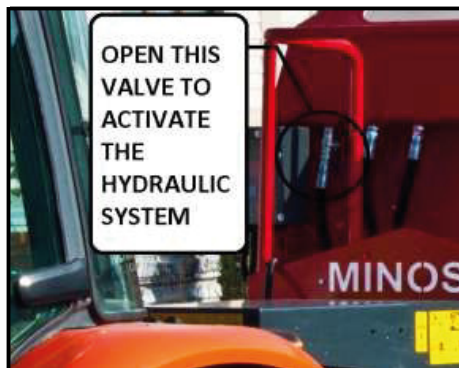
Figura 17 – Válvula del sistema hidráulico
