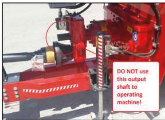
Figura 9- Conexión de la toma de fuerza
