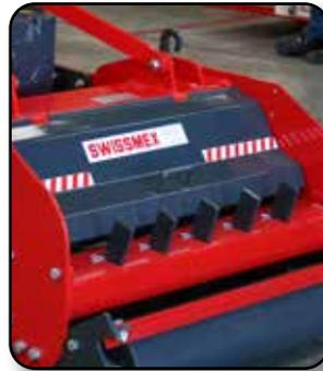
Cortina metálica ajustable en 3 posiciones, permite controlar el flujo de material.
