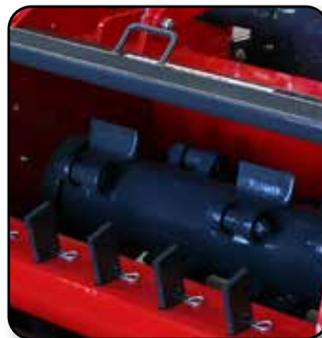
Los 10 martillos de hierro forjado tienen gran potencia en el impacto sobre el material debido al amplio diámetro del rotor lo que garantiza un mayor triturado.
