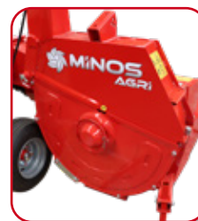
Volante de picado con 12 navajas y 6 palas lanzadoras
