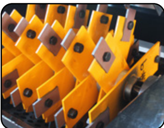
Martillos fijos de grueso calibre (1/4-6.4mm) de acero especial resistente al impacto y a la corrosión
