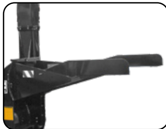
Amplia boca de alimentación con extensión de soporte para pacas
