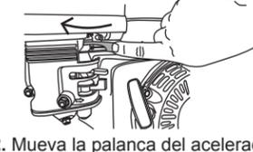
2. Mueva la palanca del acelerador 1/3 de su carrera hacia la posición de rápido.
