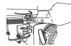
**NOTA:** Una vez encendido el motor regrese rápidamente la palanca del ahogador a su posición de abierto.
