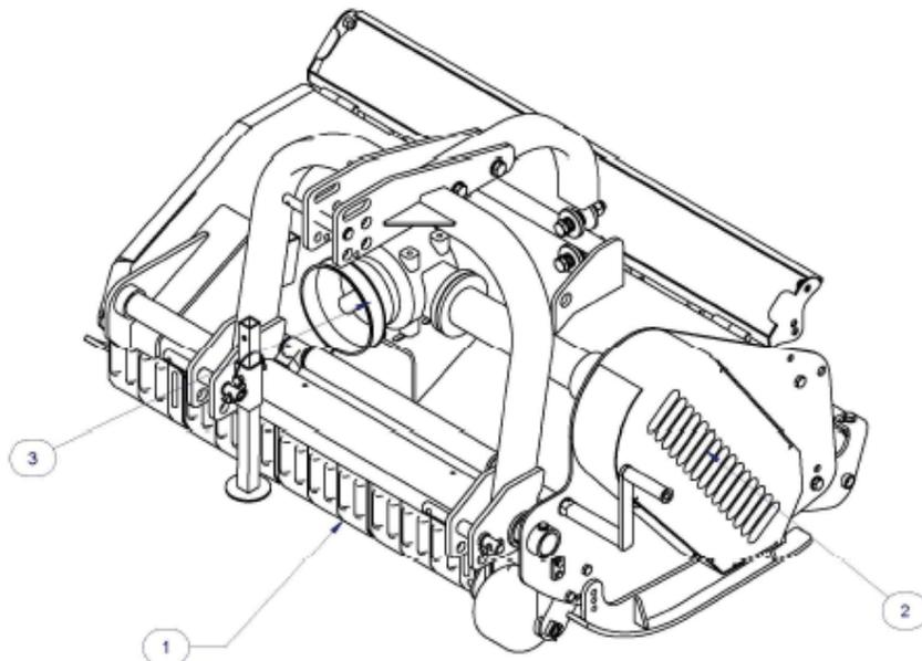
*Fig. 16 DISPOSITIVI DI SICUREZZA DELLA TRINCIA*
