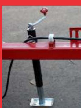
Pata para soporte, de activación mecánica
