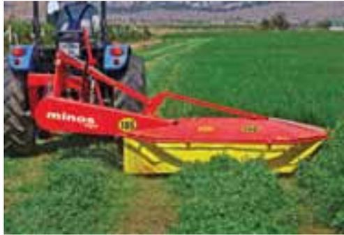
**Figura 4: Conexión al tractor**
