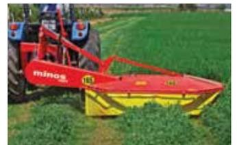
**Figura 9. Bajada de la segadora de la posición de transporte a la posición de trabajo**
