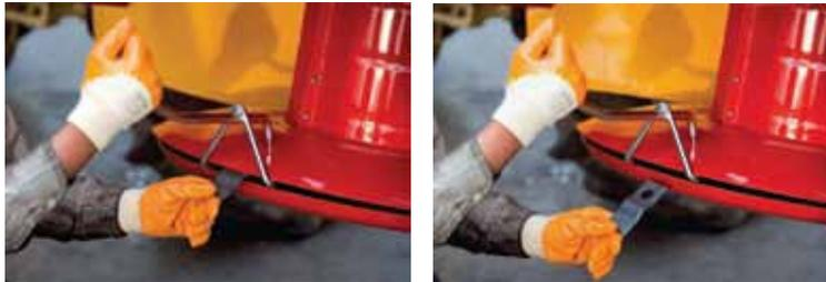
Figura 17. Reemplazando las Cuchillas
