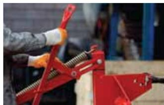
**Figura 7. Desconecte el resorte tensor.**
