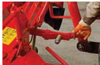
**Figura 8. Conecte el pasador de tensión y control.**
