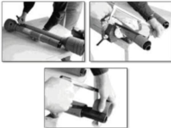
**Figura 5. Ajuste de la longitud del eje P.T.O. a la dimensión adecuada para el tractor.**
