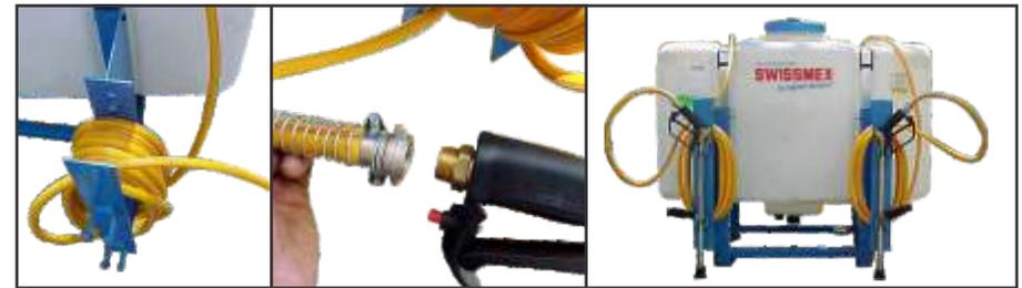
4.- Inicie enredando la manguera de alimentación de las pistolas en el porta pistolas, posteriormente coloque el extremo de la manguera en la que se localiza el niple paloma y el resorte en la rosca de la pistola y apriete de igual manera proceda de la misma manera con la otra manguera.
