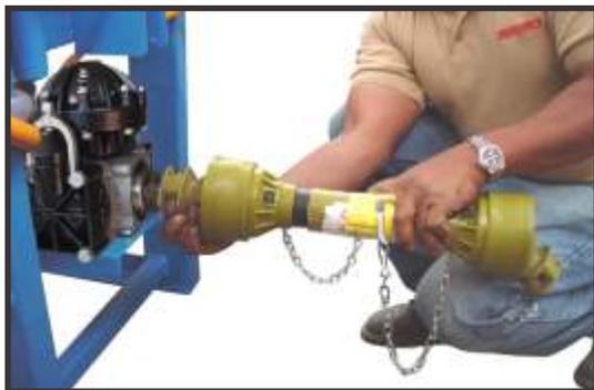
11.- Coloque el eje cardán en la bomba y fije la cadena en algún punto para evitar que gire cuando está en posición de trabajo.
