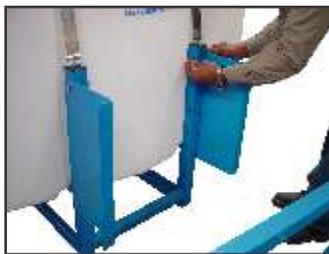
2.- Coloque las placas a la altura deseada y fíjelas con los tornillos, apriete firmemente.
