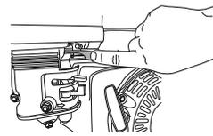
5. Mueva la palanca del acelerador a su máxima potencia.
