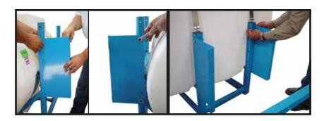
3.- Instale el aguilón a la altura requerida y fíjelo con los tornillos 3/4 X 3/8", apriete firmemente.
