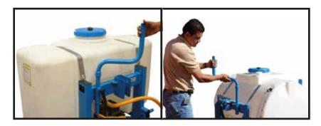
6.- Coloque el regulador con el manómetro hacia el tractor y apriete con la manija.
