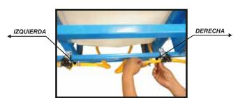
9.- Coloque el eje cardán en la bomba y fíje la cadena en algún punto para evitar que gire cuando está en posición de trabajo.
