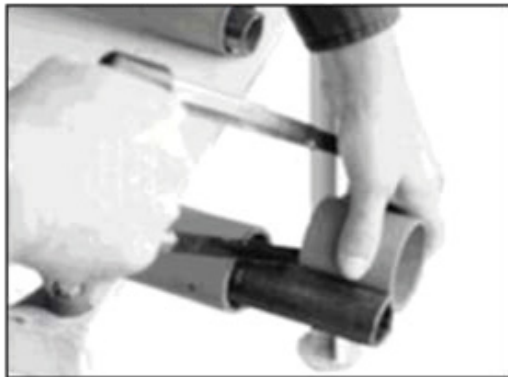
Figura 14.c- El acortamiento del eje de la toma de fuerza
