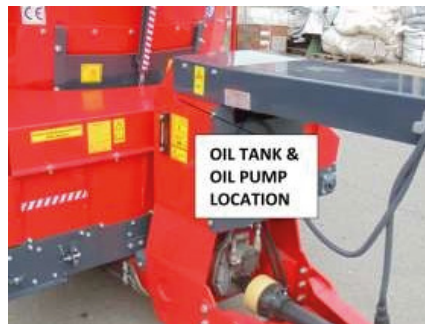
Figura 17 – Tanque de aceite y localización de la bomba de aceite.
