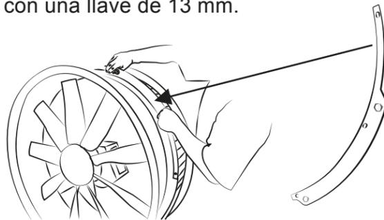
10. Quite los tornillos de la turbina que se encuentra en la parte trasera (del lado del tanque) con llave de  $\frac{1}{2}$  y llave de 5 mm. Son dos piezas, las dos inferiores.
