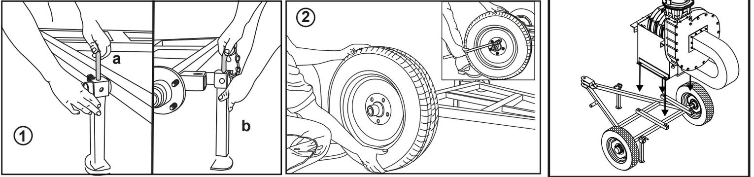
**NOTA:** Para levantar el molino usted requiere montacargas o polipastos de mínimo de 500 kg (1102.31 lbs). Los pasos del punto 1 al 3 no aplica para los modelos 610120, 610125, 610130, 610135 estos vienen armados con sus chasis.
