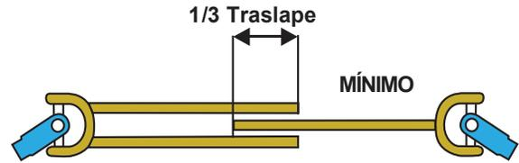
**NOTA:** Identifique que lado va al tractor y que lado al molino (en la etiqueta que tiene la toma de fuerza). Recuerde que el tubo hembra siempre va al lado del tractor y el tubo macho al lado del implemento.
