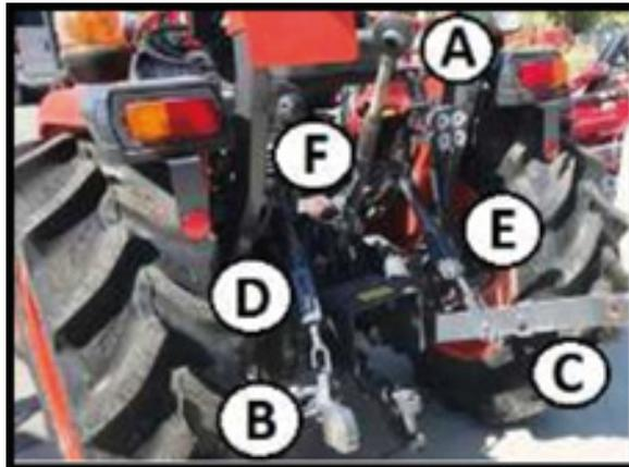
Figura 11- Partes del enganche de 3 puntos del tractor
