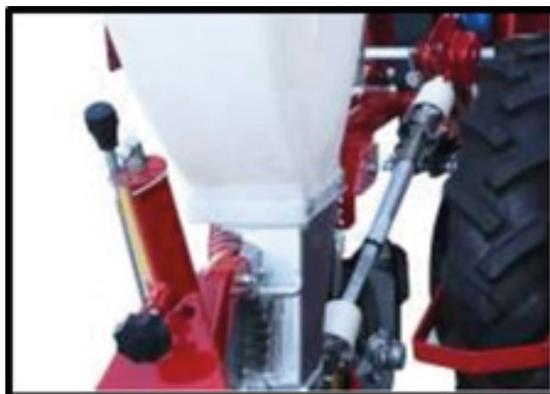
Figura 2- Eje de transmisión de la unidad de siembra
