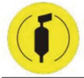
Figura 38- calcomanía de puntos de lubricación
