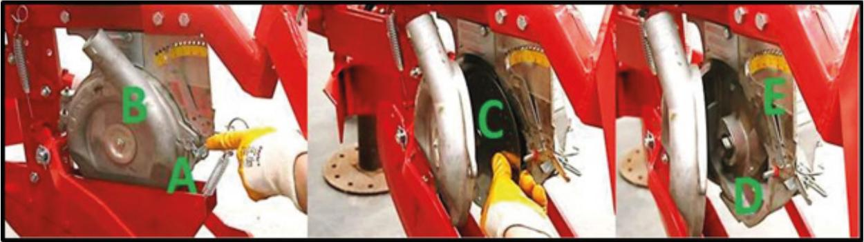
Figura Compuesta 19- Remplazo de plato de semillas
