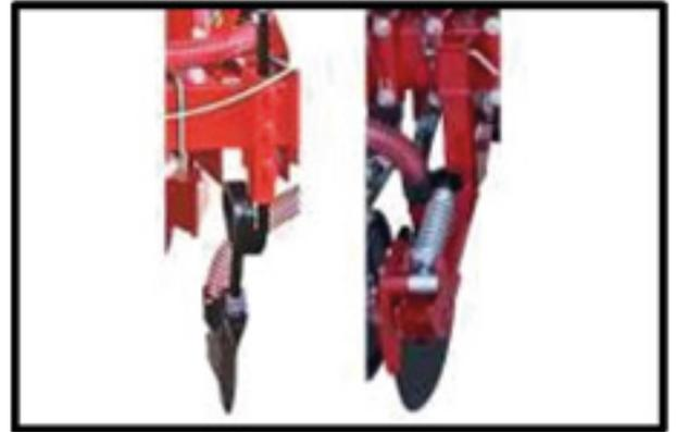
Figura 4- Pata fertilizante de cuchilla y de disco
