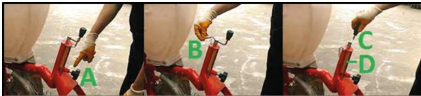
Figura Compuesta 30- Ajuste de profundidad de siembra
