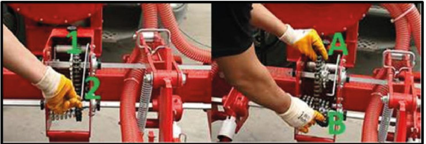
Figura Compuesta 29- Ajuste de la caja de cambios con el par de engranes identificados (A-B)
