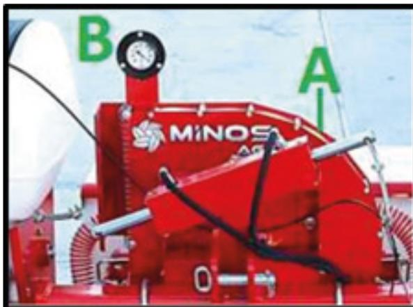
Figura 25- Localización del impulsor y del vacuómetro.
