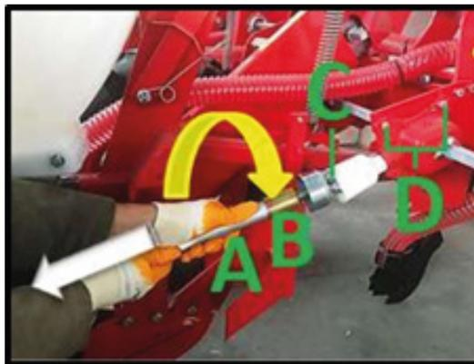
Figura 33- Desactivación del eje de transmisión de la unidad de siembra
