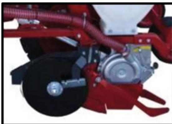
Figura 3- Sembradora tipo Discos+Cuchillas
