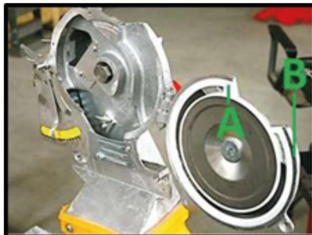
Figura 20- Localización del empaque de la cubierta
