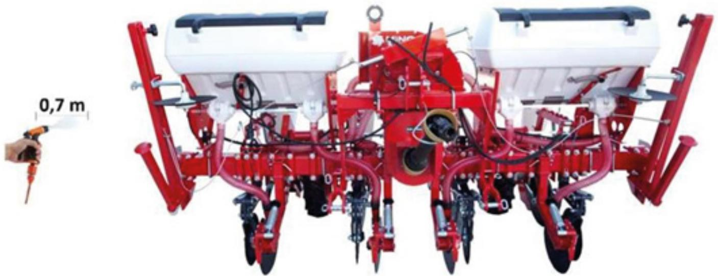
**Figura 40- Distancia segura entre el chorro de agua y la máquina**
