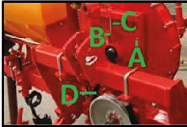
Figura 26- Tensión de la banda del ventilador
