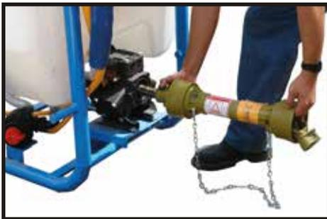
8.- Coloque el eje cardán en la bomba y fije la cadena en algún punto para evitar que gire cuando está en posición de trabajo.
